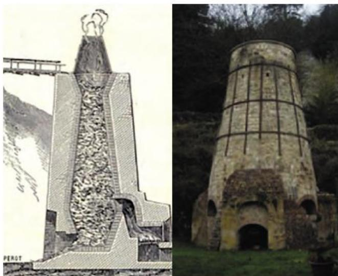
1/ Schéma de four à chaux le long d'une falaise.
